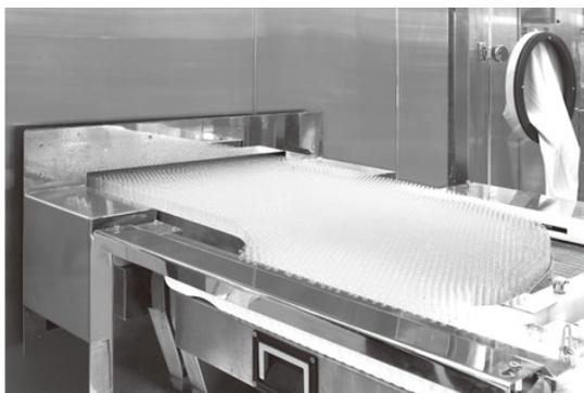
**Сфера применения и функционал:** Высокотемпературная стерилизация флаконов и ампул
