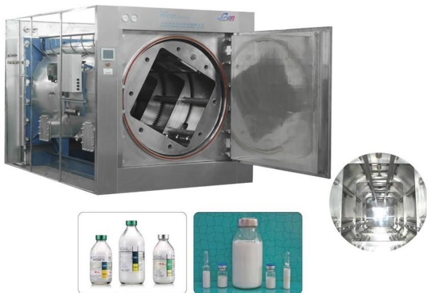
Данная модель автоклава предназначена для стерилизации перегретой водой и непрерывной вращение тележки с продуктом для поддержания стабильности и однородности суспензии и предотвращения их расслоения. Кроме того, из-за того, что в процессе стерилизации продукт непрерывно переворачивается и перемешивается, улучшается равномерность распределения температуры и скорость теплопередачи в продукте, тем самым повышается эффективность стерилизации.
