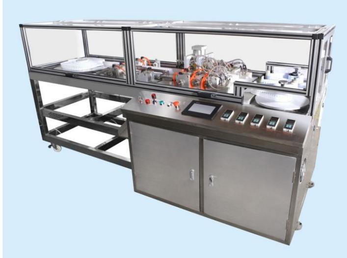
Данное оборудование предназначено для производства готовой ячеистой упаковки для последующего розлива в нее суппозиторной массы.
