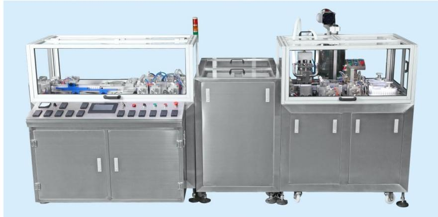
Данное оборудование предназначено для производства ячеистой упаковки, розлива в нее суппозиторной массы, запайки и резки в лабораториях, клиниках, больницах, учебных заведениях.
