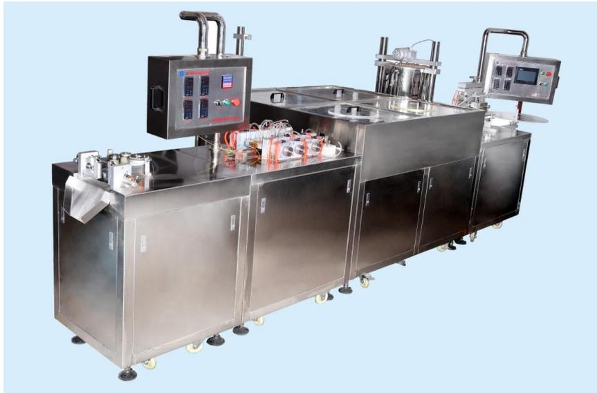
Данное оборудование предназначено для производства ячеистой упаковки, розлива в нее суппозиторной массы, запайки и резки.
