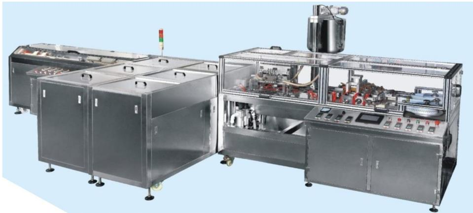
Данное оборудование предназначено для производства ячеистой упаковки, розлива в нее суппозиторной массы, запайки и резки.
